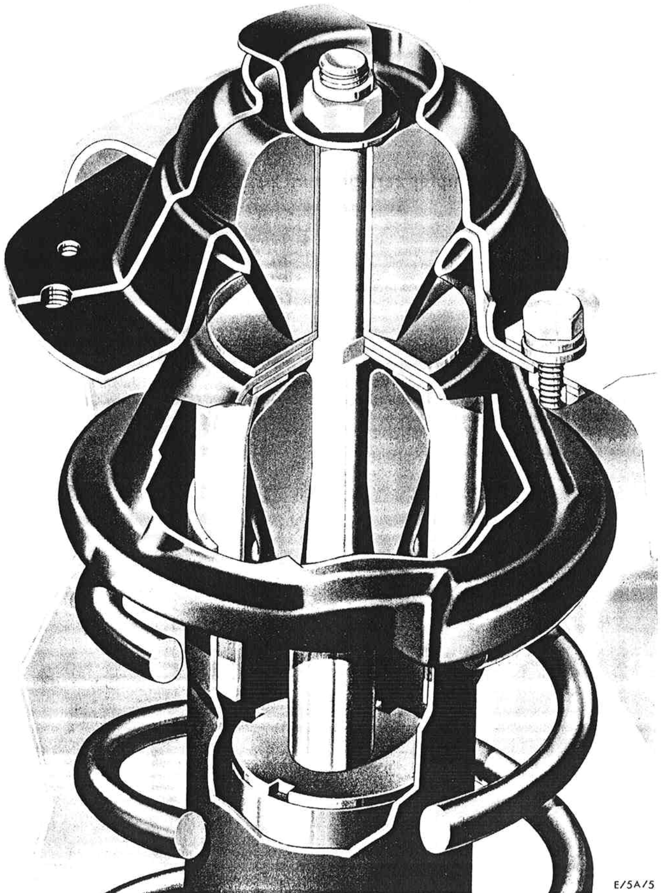
Federbein im Schnitt (verstärkte Ausführung)
