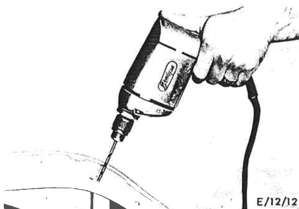
Nieten an der vorderen Fensterführung ausbohren
